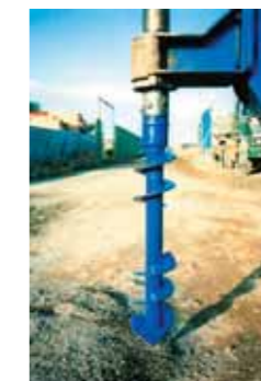
試掘用特殊ロッドで、改良部の土を1m毎に採取し、土質の確認と支持層の深さの確認を施工前に実施します。
