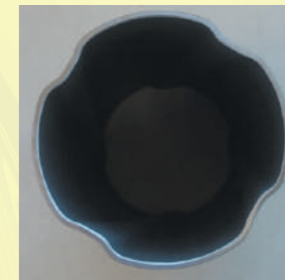
押し抜き試験
