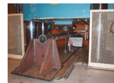
タイガーパイル曲げ試験状況 (試験後)
