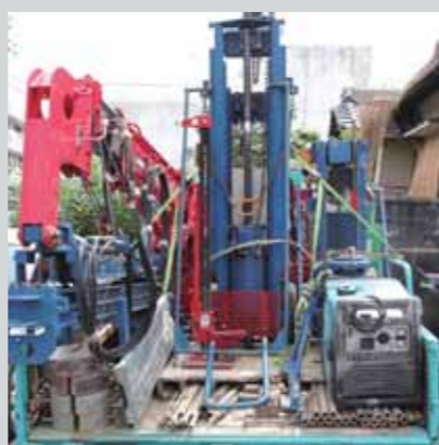
土取機、SWS試験機と、ラム試験機 3タイプを調査車両に搭載可能
